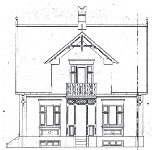
Fig.27. Genetablering af oprindelige verandaer og lignende mindre påbygninger tillades, hvis det kan dokumenteres ved originale bygningstegninger eller fotografier, der er taget omkring bygningens opførelsestidspunkt. Her ses original bygningstegning, der viser veranda og indgangsparti samt gavludsmykning og brandstage i træ. Desuden ses skorstenen med stor detaljerigdom
