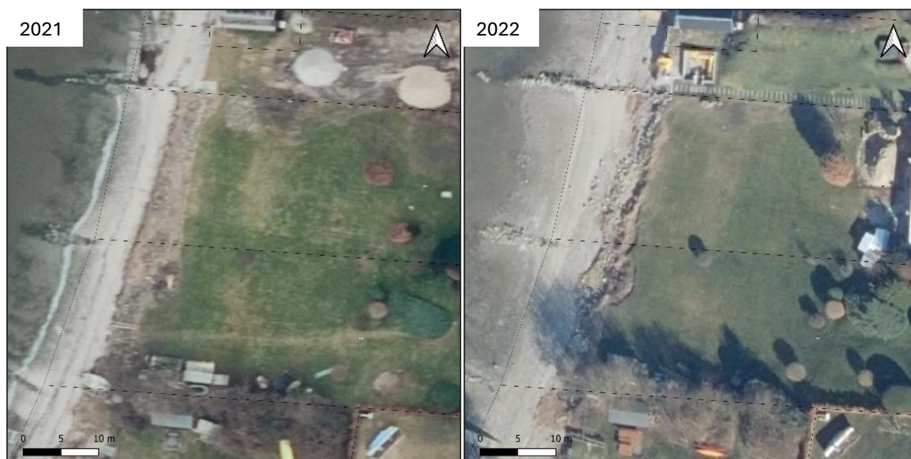
Figur 4.42: Frederiksborgvej 173,177,179B, erosion af skrænten efter stormen Malik i 2022.
