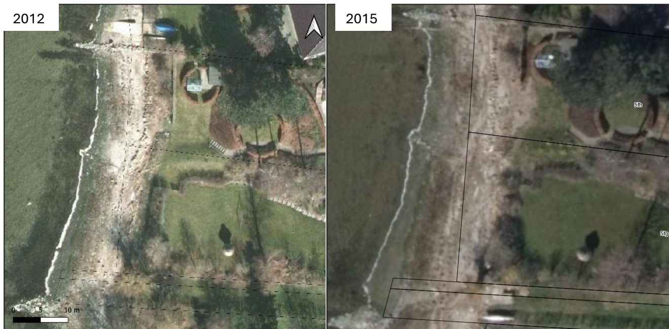
Figur 4.21: Frederiksborgvej 123B og 123C, erosion af skrænten mellem 2012 og 2015. (Foto fra 2014 var for mørkt).
