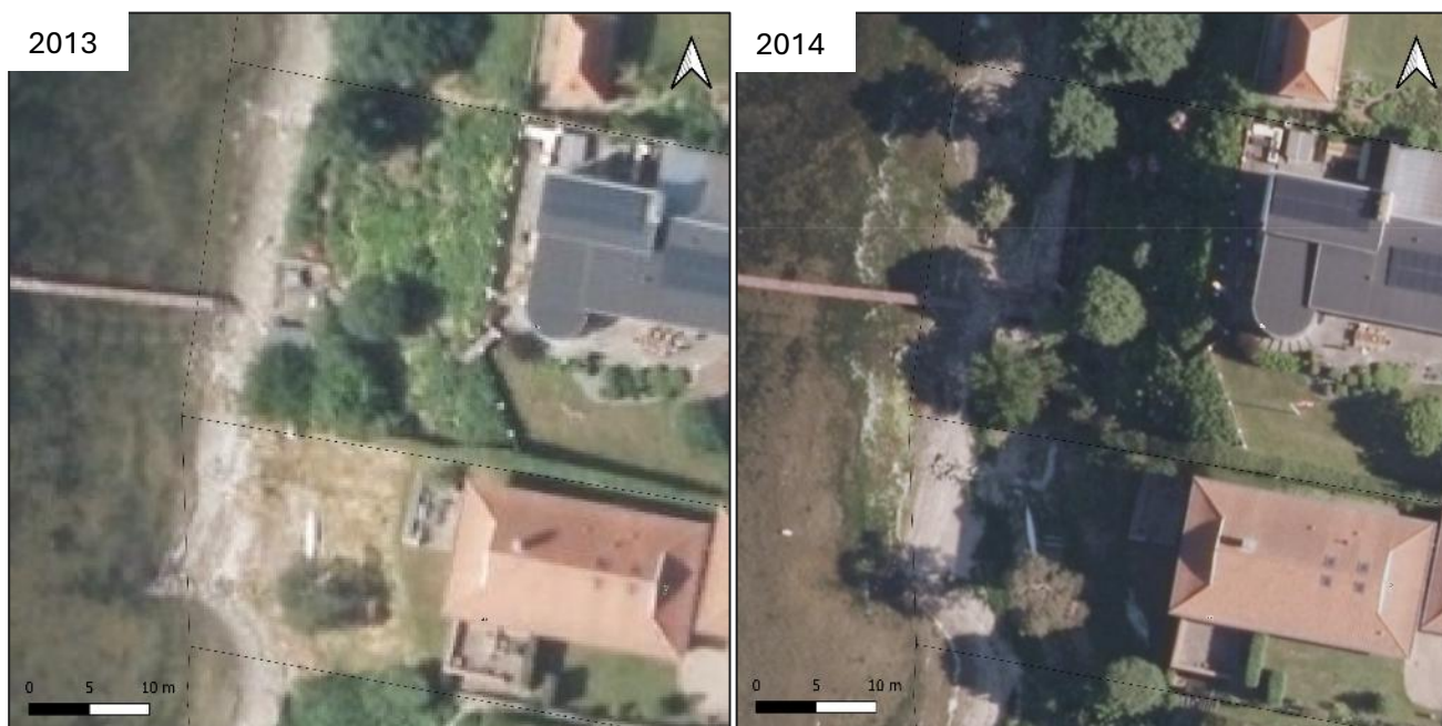
Figur 4.15: Frederiksborgvej 105D og 105H, erosion af skrænten efter stormen Bodil i december 2013.
