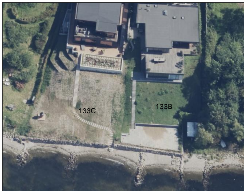
Figur 4.26: Frederiksborgvej 133B og 133C, kystbeskyttelse i foran af mur/stenkastning. Skråfoto 2023.
