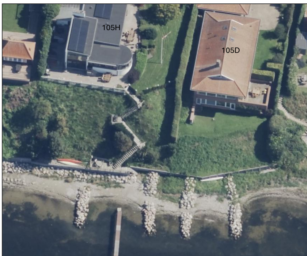
Figur 4.14: Frederiksborgvej 105D og 105H, væg med stenkastning samt høfder, skråfoto 2023.
