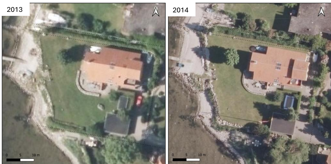
Figur 4.6: Frederiksborgvej 101A, erosion bag skråningsbeskyttelsen efter stormen Bodil i december 2013.
