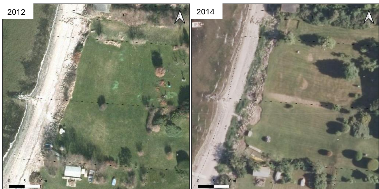
Figur 4.41: Frederiksborgvej 173, 177, 179B, erosion af skrænten efter stormen Bodil i 2013.
