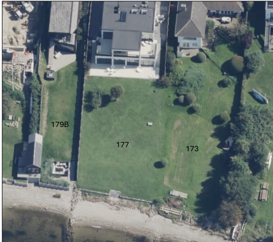
Figur 4.40: Frederiksborgvej 173, 177, 179B, kystbeskyttelse i form af stenkastning ved nr. 173 og mur ved nr. 177 og 179B. Skråfoto 2023.
