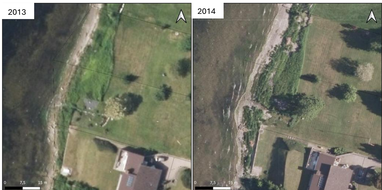
Figur 4.37: Frederiksborgvej 147, 151 og 153, erosion af skrænten mellem 2013 og 2014.
