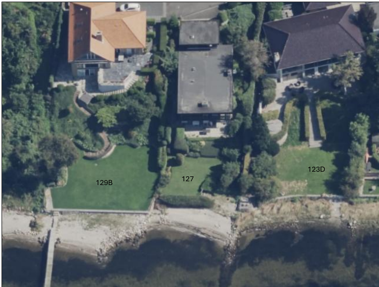
Figur 4.22: Frederiksborgvej 123D, 127, og 129B, kystbeskyttelse i form af mur og høfder. Skråfoto 2023.
