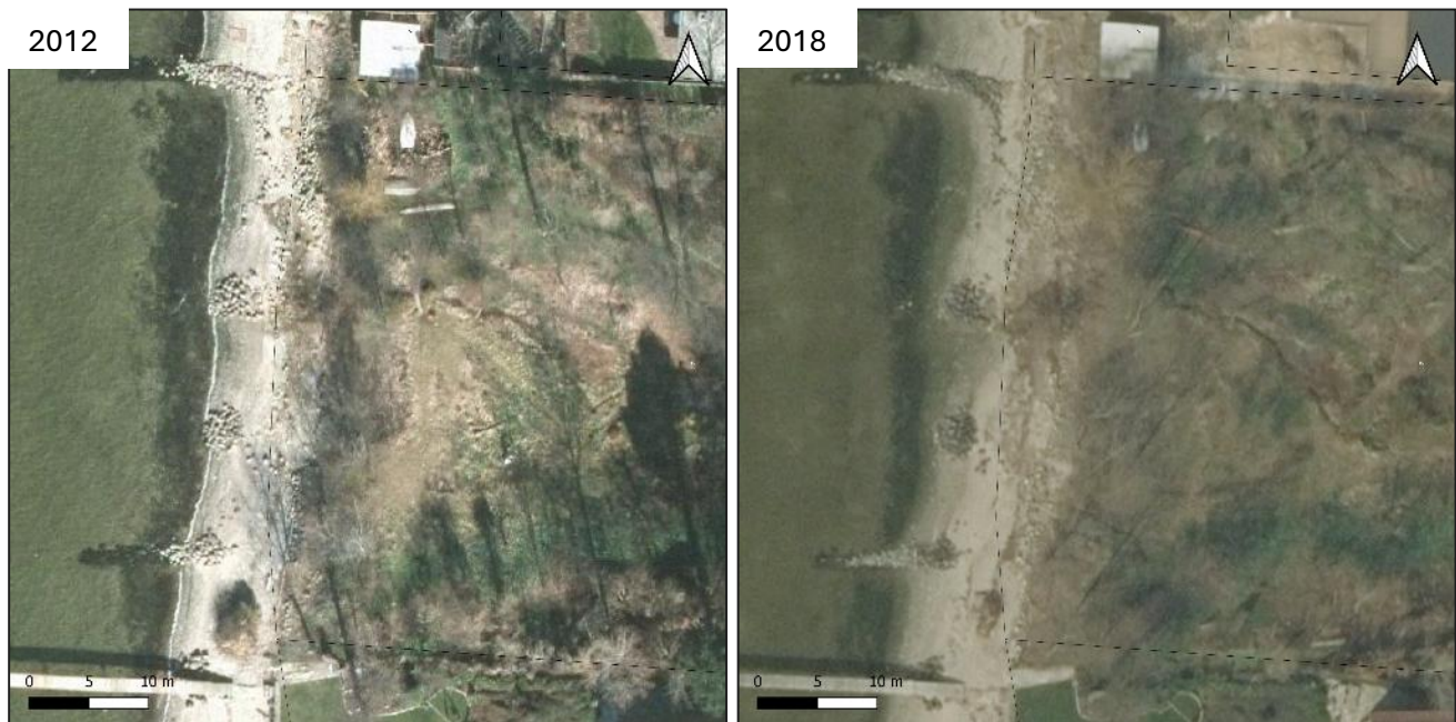
Figur 4.24: Frederiksborgvej 131C, erosion af skrænten mellem 2012 og 2018.
