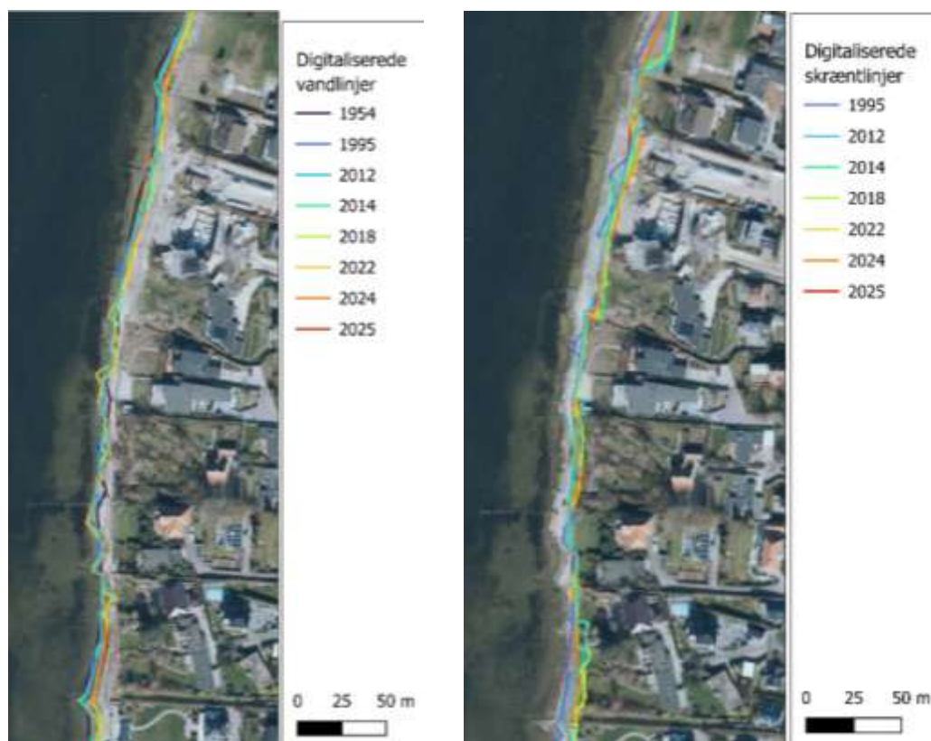
Figur 1a vandlinje og skræntlinje. Tv. vandlinje mellem 1954 og 2025. Th. skræntlinje mellem 1995-2025. Kilde Niras: Behov for skræntbeskyttelse Frederiksborgvej 87-205 Ortofoto 2025
