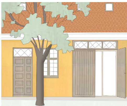
Fig.29. De eksisterende porthuller kan omdannes til nye tredelte vinduespartier med porte foran. © Peter Kjær Arkitekter
