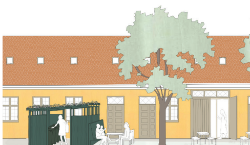
Fig.36. Affaldstationerne skal opføres i træ bemalet vogngrønt. De skal overdækkes med pergola med åbne mellemrum og begrønnes med klatreplanter. © Peter Kjær Arkitekter
