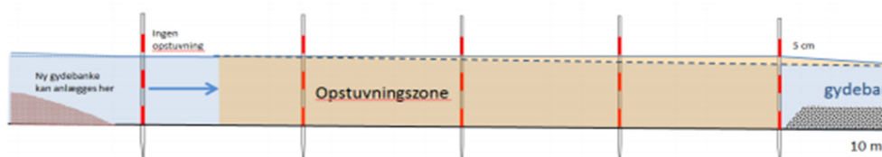
Figur 9 Principskitse for, hvordan man vha. landmålerstokke med markeringer af vandstandsforholdene kan sikre sig, at man ikke påvirker opstrøms beliggende områder, når man udlægger en eller flere gydebanker.
