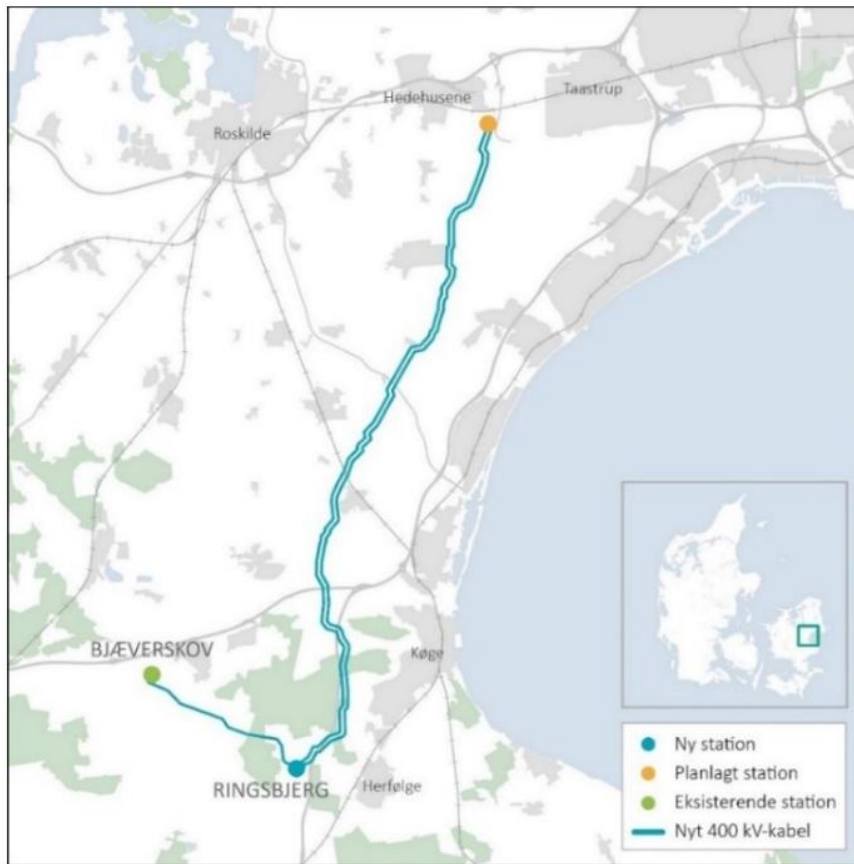
Figur 1: Oversigtskort fra ansøgningsmaterialet over linjeføring af kabelanlæg for hele projektet.
