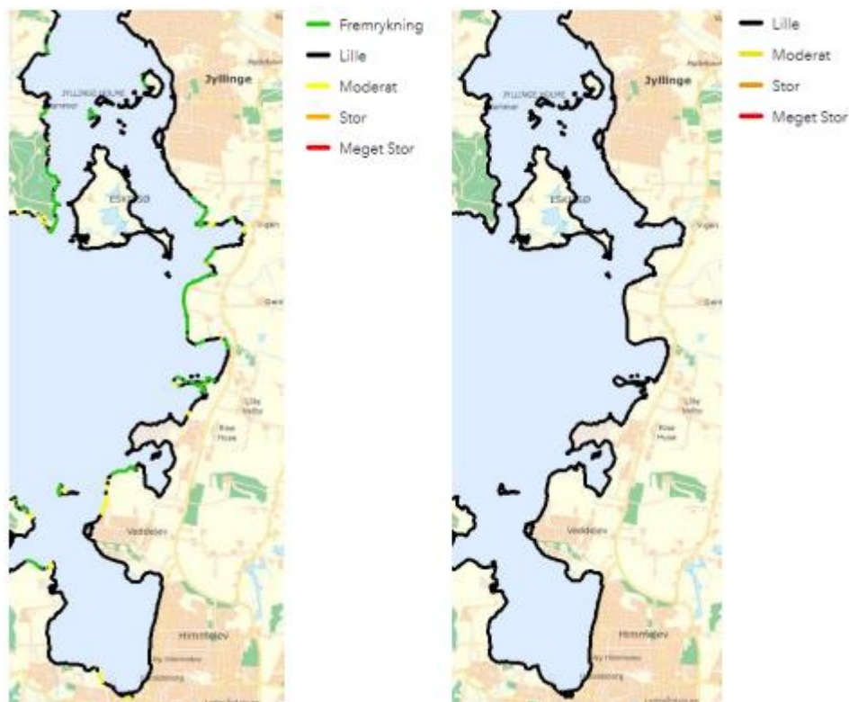
Figur 11-1 Erosionsfare: Kronisk erosion (venstre). Akut erosion (højre). 31
