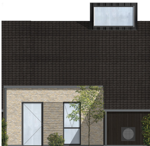
Fig.24. Byggefelt 2-3 eksempel på facade med relieffvirkning mellem vinduer og dørpartier.
