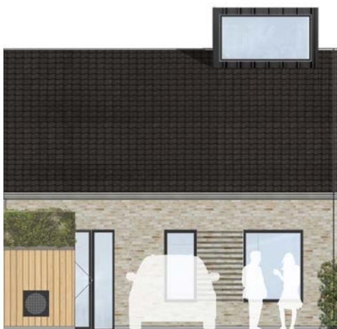
Fig.21. Byggefelt 1 -eksempel på facade med relief-virkning mellem vinduer og dørpartier.
