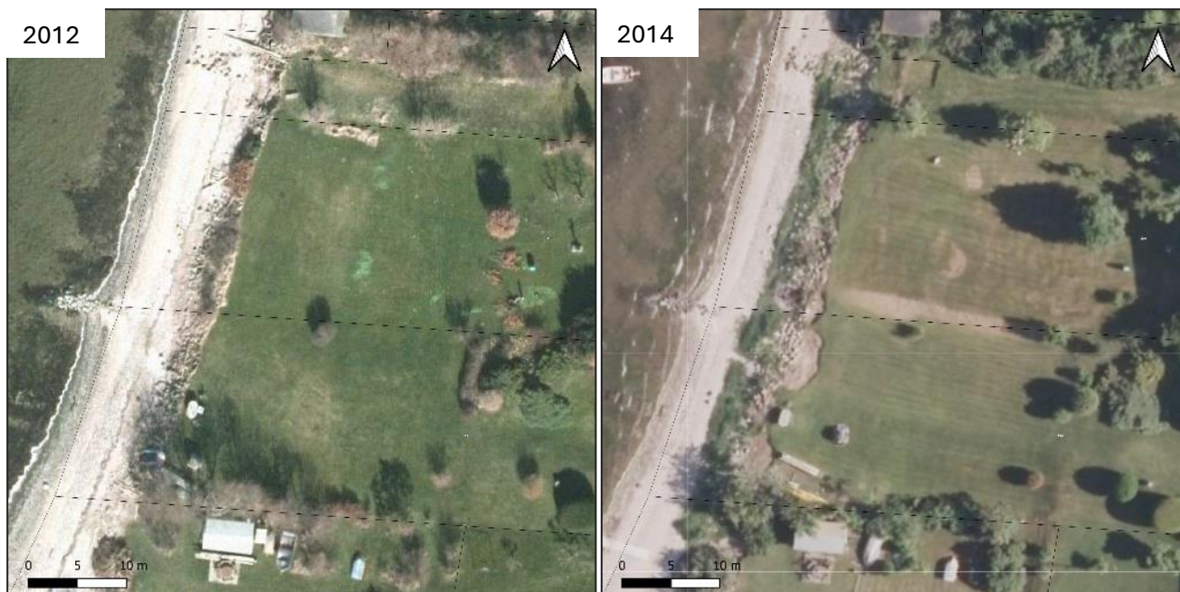
Figur 2.8: Frederiksborgvej 173 og 177, erosion af skrænten efter stormen Bodil i 2013.
