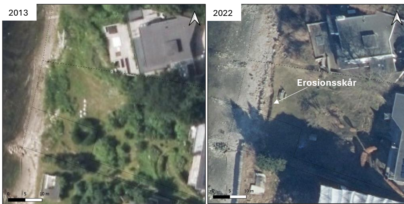
Figur 2.5: Frederiksborgvej 135B, 135D og 135E, samt hjørnet af 137, erosion af skrænten i perioden 2013 til 2022.
