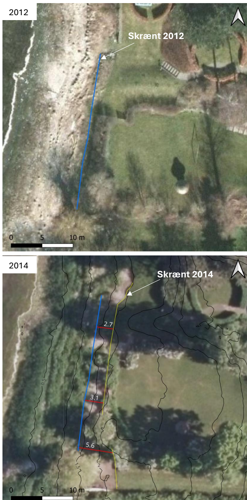
Figur 2.2: Frederiksborgvej 123B og 123C, erosion af skrænten mellem 2012 og 2014. Blå linje indikerer skræntens placering i 2012, gul linje indikerer skræntens placering i 2014, sorte linjer viser 0,5 m højdekurver fra 2015 højdemodellen, og røde linjer viser forskellen mellem de to skræntlinjer med længden angivet i meter.
