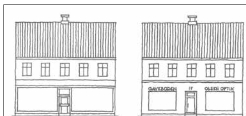
Fig.30. Store udstillingsvinduer skærer huset over. Huset skal stå solidt plantet på jorden. En helhed fra terræn til tag
