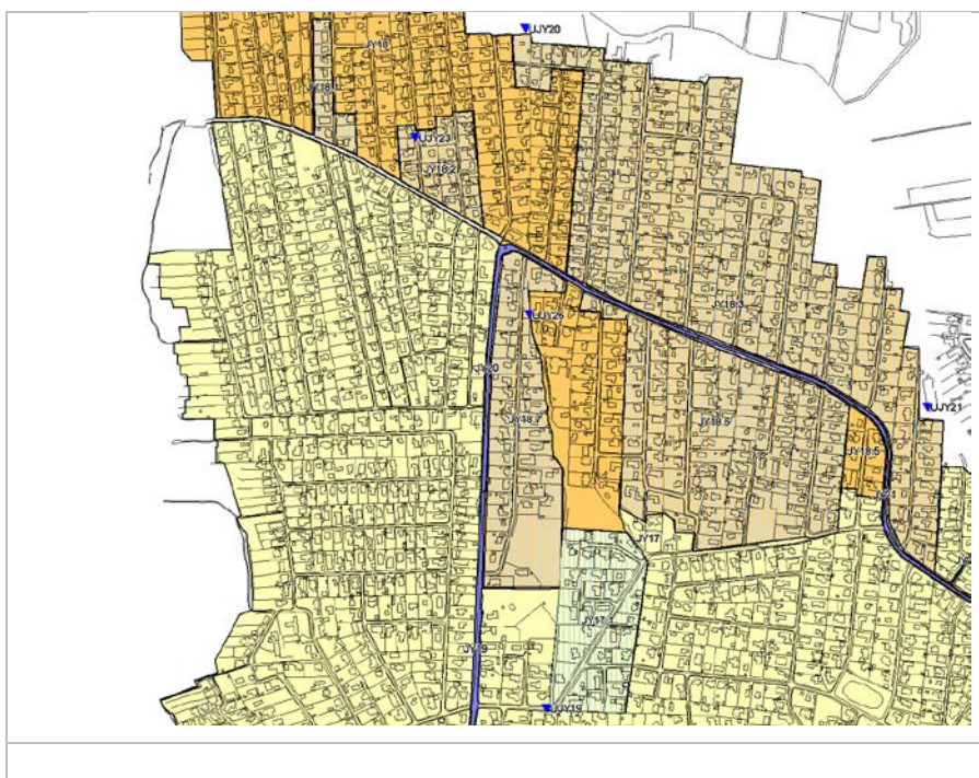
Figur 2: Tegning 2 (nedskaleret) over planlagte afledningsforhold for regnvand. Der henvises til selve tegningen i bilag for detaljer.
