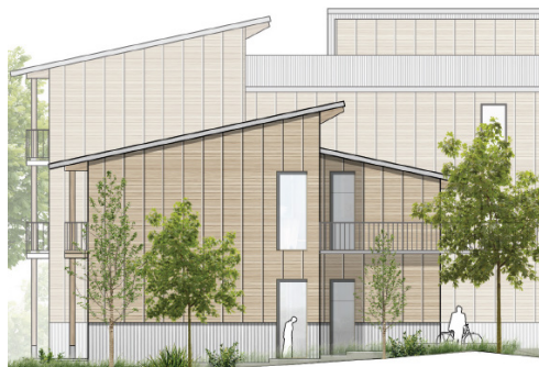
Fig.15. Tage skal udformes med forskudte, ensidige tagflader, der rejser sig mod bygningskroppens midte, så de får karakter af dobbelt pulttage. Facadehøjden skal være lavest mod gårdrummet. Terrænfald skal optages i byggeriets sokler © Loop Architects & Kragh Berglund
