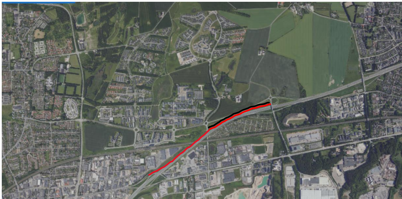
Figur 1: med rød streg er angivet hvor der ikke er støjskærm mellem Holbækmotorvejen og boliger i Trekroner. Med sort fremgår Trekroner støjvold.
